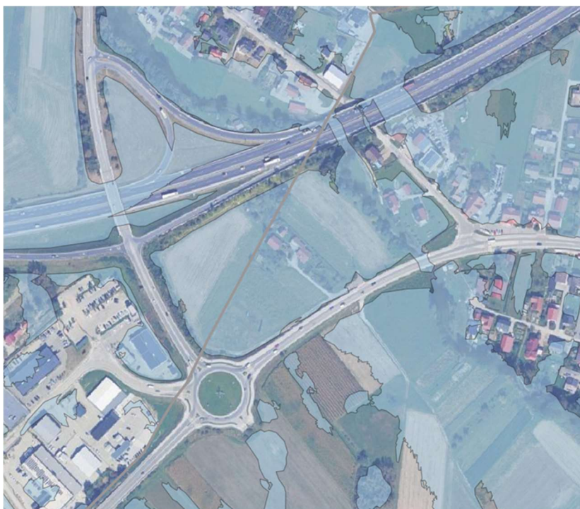
Slika 4: Prikaz ogroženih območij, fluvialne in pluvialne poplave prikazane z modro barvo (vir: Atlas voda)
