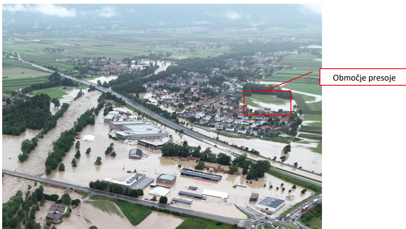
Slika 7: Lasten DRON posnetek v času visokovodnega dogodka. Vzpostavil se je poplavni tok, primerljiv s sliko 6.
